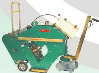
Staubfreies Kugelstrahlen bis Arbeitsbreite von 715 mm: die Betonoberfläche wird fachgerecht für die Beschichtung (Abdichtung nach ZTV- Haftzugwert 1,5 N/mm 2 ) vorbereitet - letzte Rückstände entfernt und gleichzeitig porentief gereinigt
